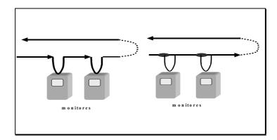
Las figuras muestran las diferentes configuraciones para garantizar la circulación constante del agua, hasta el monitor. A la izquierda, instalación en **U**, y a la derecha, con anillos secundarios.
